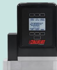
美国 ALICAT ISMCW 系列本安防爆低压损型气体质量流量控制器, ia 区域本安防爆认证, 可用于 0 区环境直接测控, 无需额外的阀门配置; 采用内部补偿型层流压差技术, 使得大流量范围内气体仍旧保持层流运动。内置的绝压和温度传感器充分补偿因压力和温度引起的体积流量与质量流量间的差异, 并对用户标准工况进行修正。具有 NIST 可溯源校准证书。
