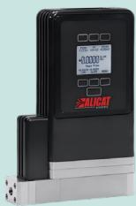
美国 ALICAT ISMCS 系列本安防爆气体质量流量控制器, ia 区域本安防爆认证, 可用于 0 区环境直接测控, 无需额外的阀门配置; 可用于快速准确地测量并控制腐蚀性气体 (如: NH<sub>3</sub>、H<sub>2</sub>S、SiH<sub>4</sub> 等) 的质量流量、体积流量、压力, 并显示气体温度。采用内部补偿型层流压差技术, 使得大流量范围内气体仍旧保持层流运动。内置的绝压和温度传感器充分补偿因压力和温度引起的体积流量与质量流量间的差异, 并对用户标准工况进行修正。具有 NIST 可溯源校准证书。
